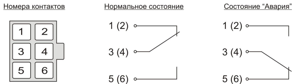
Рисунок 5 Номера контактов и состояния реле
