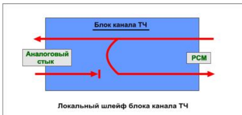
Рисунок 5 - Схема передачи сигнала при включенном локальном шлейфе
