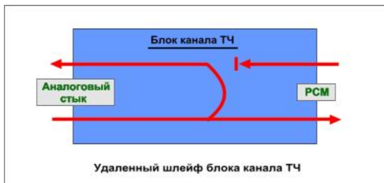
Рисунок 6 - Схема передачи сигнала при включенном удаленном шлейфе
