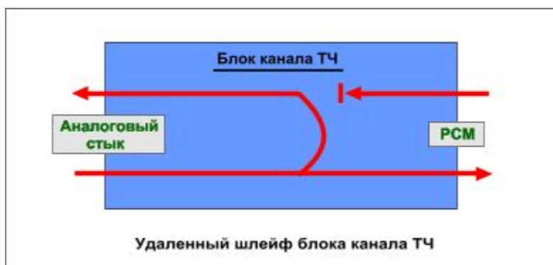
Рисунок 9 - Схема передачи сигнала при включенном удаленном шлейфе
