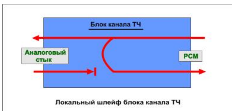
Рисунок 8 - Схема передачи сигнала при включенном локальном шлейфе
